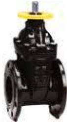
15/78 Serisi Flanşlı sürgülü vana ISO tepe flanşlı DN50-400 PN10/16 Sfero dökme demir PUR dış kaplama
