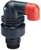
701/40 Serisi Çift küreli vantuz DN20, 25 ve 50 ¾", 1" veya 2" BSP dişli PN16 Güçlendirilmiş plastik
